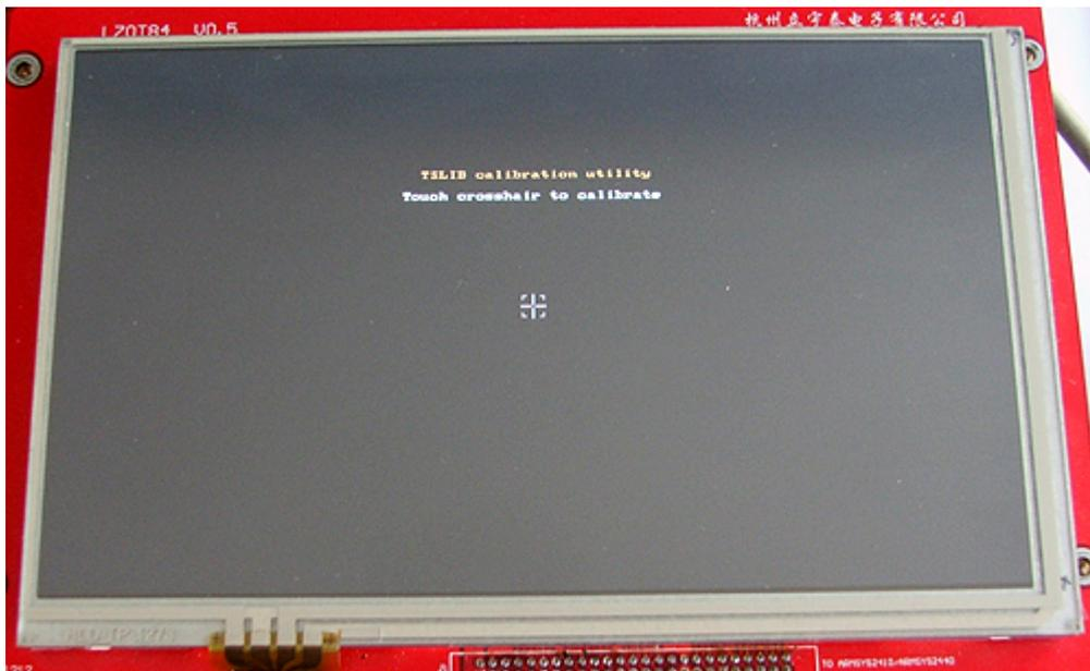
准确点击 5 个校准点，tslib 程序将自动产生校准数据，您可以通过 Qtopia 自带的手写输入法等，
