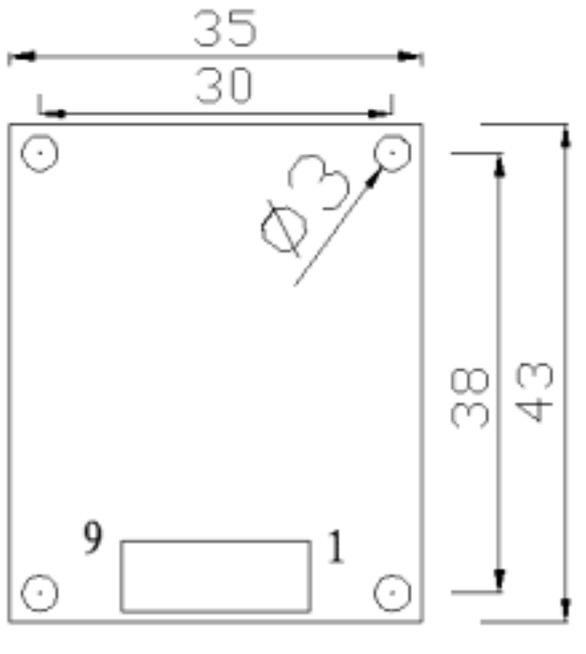
4. AT201-SC232-CBB(AT101-SC232-CBB) 电路板插座定义及电路板机械尺寸：
