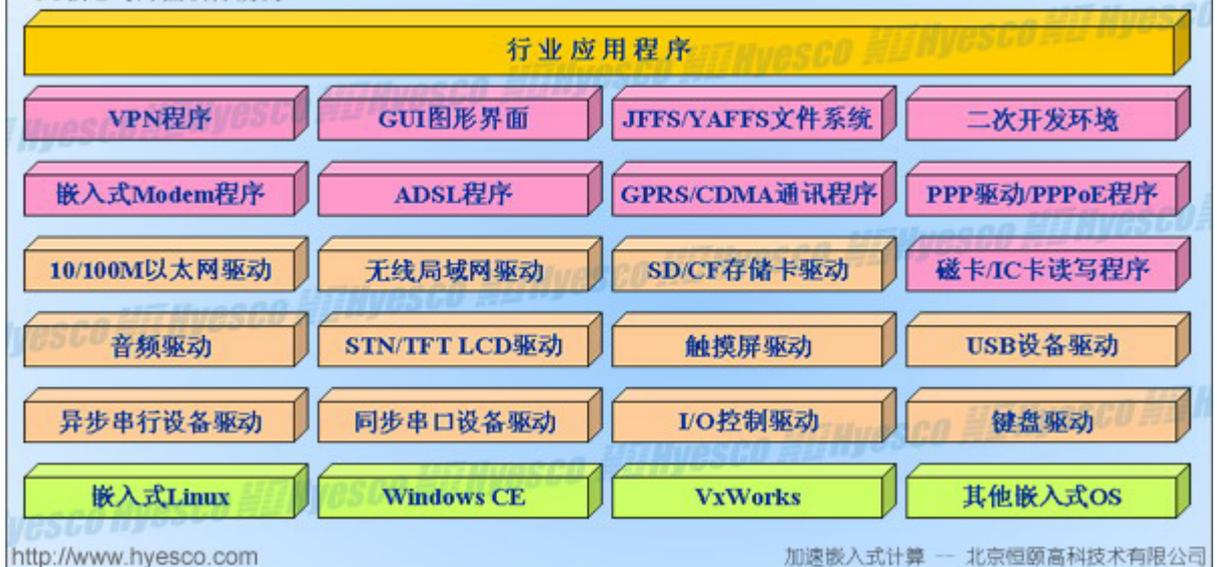
在嵌入式操作系统如 WinCE 和 Linux 等之上，各种底层驱动程序、应用程序与通讯程序、图形环境程序协同工作，可以实现桌面式 POS、轻便型 POS、无线移动型 POS，实现
