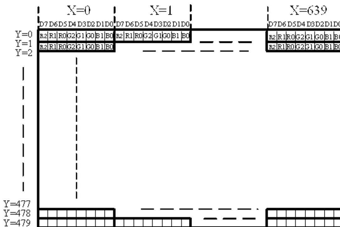
图 2 显示存储器与像素对应关系
