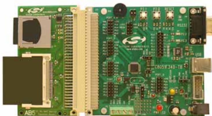
图 3：采用 C8051F340-TB 的 Silicon Laboratories 大量存储装置参考设计
