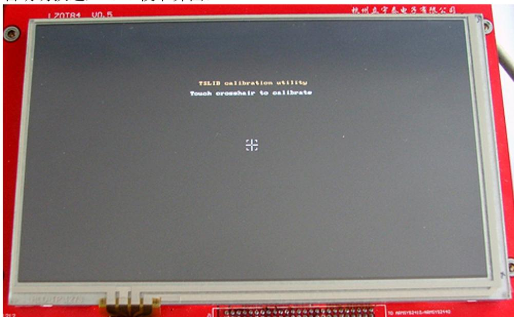
准确点击 5 个校准点，tslib 程序将自动产生校准数据，您可以通过 Qtopia 自带的手写输入法等，来测试校准效果。
