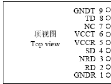
图 A-4 光口的引脚定义图
