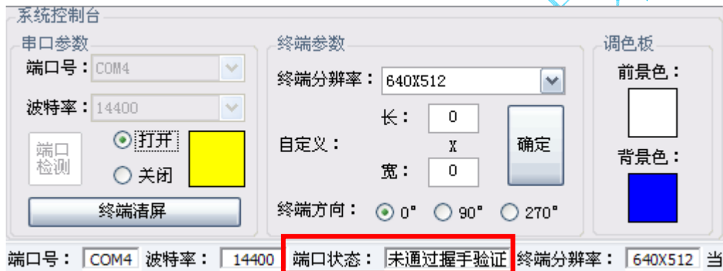
图 3-3-4 串口打开正常但和终端握手失败的界面
